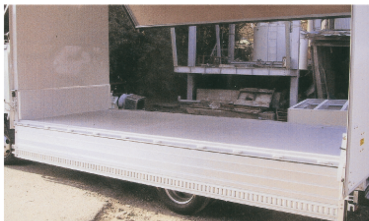
トラックボデー腐食防止FRPライニング
